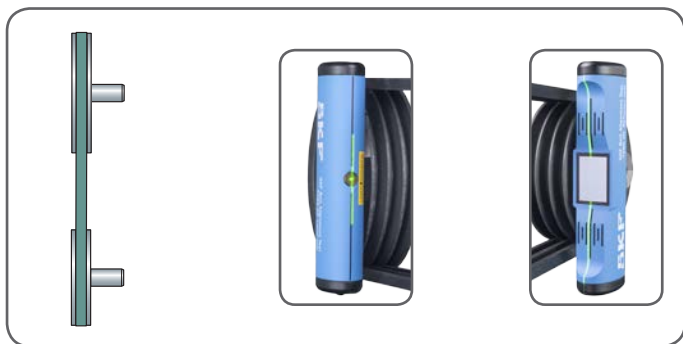
Рисунок 9 Соосность шкивов после правильно выполненной выверки
