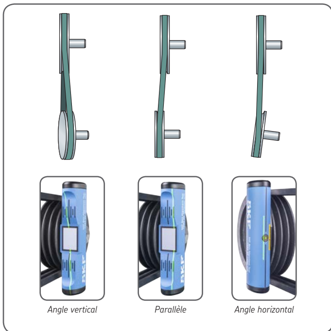
Figure 5 Résumé du désalignement
