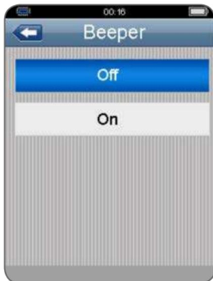
Нажмите кнопки UP и DOWN для выбора режима работы звукового сигнала, нажмите кнопку ESC для выхода и сохранения выбранного режима.
