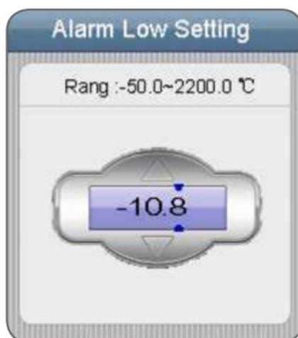
Pulse el botón ENTER en la primera fila y utilice los botones ARRIBA y ABAJO para ajustar el valor. Pulse el botón ENTER para confirmar; pulse el botón ESC para salir y guardar.
