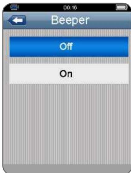
Drücken Sie die AUF- und ABWÄRTS-Taste, um den Signaltonstatus zu wählen. Drücken Sie zum Verlassen des Menüs und zum Speichern des gewählten Signaltonstatus die ESC-Taste.
