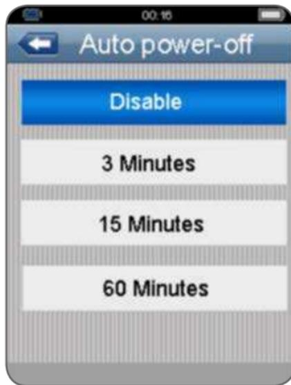
按向上 (UP) 和向下 (Down) 按钮可选择自动关闭电源的时间或从不自动关闭电源，按退出 (Esc) 按钮可退出并保存。
