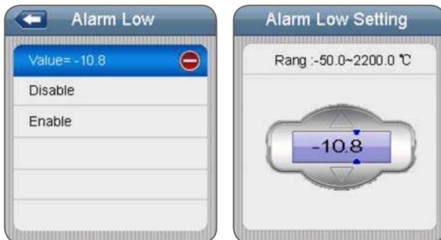
在第一行按输入按钮并使用向上 (UP) 和向下 (Down) 按钮可调整该值。按输入按钮可确认，按退出 (Esc) 按钮可退出并保存。
