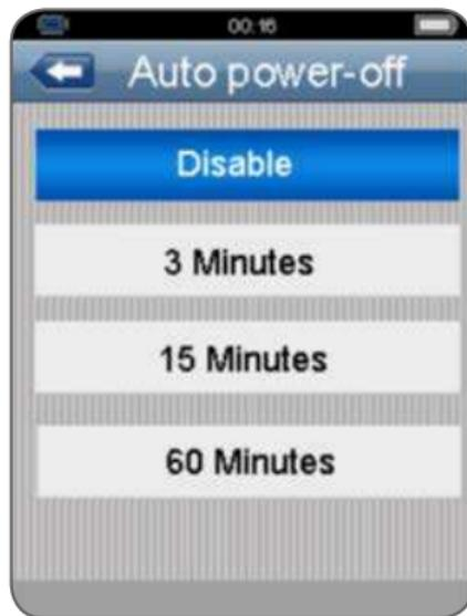
Нажмите кнопки UP и DOWN для выбора времени автоматического отключения питания или для отключения функции, нажмите кнопку ESC для выхода и сохранения.
