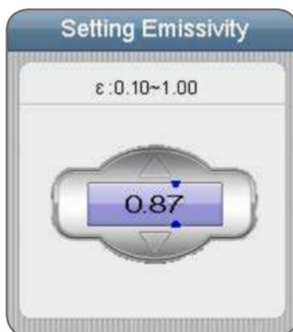
Sur le premier élément, appuyez sur le bouton Entrée pour régler l'émissivité, puis sur Haut et Bas pour ajuster la valeur et sur Entrée pour la confirmer. Appuyez sur les boutons Haut et Bas pour sélectionner les émissivités des matériaux et sur le bouton Esc pour sortir et enregistrer la sélection.
