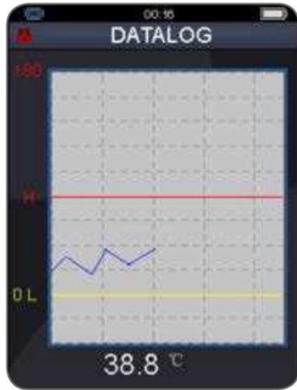
Для начала измерений в режиме регистратора нажмите однократно спусковой крючок. Нажмите кнопку ESC для выхода из режима DATALOGGER и автоматического сохранения данных во встроенной памяти или на карте памяти.
