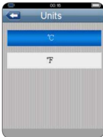
Pulse los botones ARRIBA y ABAJO para seleccionar las unidades; pulse el botón ESC para salir y guardar.
