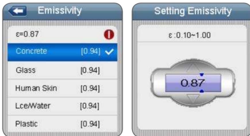
在第一个项目上按输入 (ENTER) 按钮可调整热辐射率，按向上 (UP) 和向下 (Down) 按钮可调整该值，然后按输入 (ENTER) 按钮确认。按向上 (UP) 和向下 (Down) 按钮可选择材料的热辐射率，按退出 (Esc) 按钮可退出并保存。
