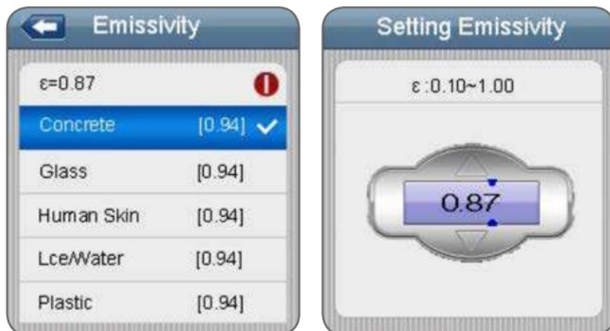
En el primer elemento, pulse el botón ENTER para ajustar la emisividad; pulse los botones ARRIBA y ABAJO para ajustar el valor, y luego pulse el botón ENTER para confirmar. Pulse los botones ARRIBA y ABAJO para seleccionar los niveles de emisividad de los materiales; pulse el botón ESC para salir y guardar.
