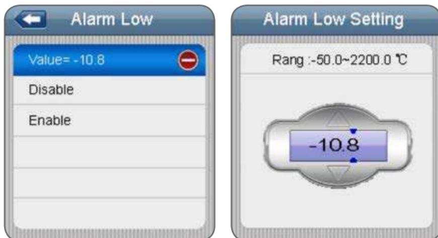
Drücken Sie die ENTER-Taste auf der ersten Reihe und verwenden Sie die AUF- und ABWÄRTS-Taste, um den Wert einzustellen. Drücken Sie zur Bestätigung die ENTER-Taste. Drücken Sie zum Verlassen des Menüs und zum Speichern die ESC-Taste.
