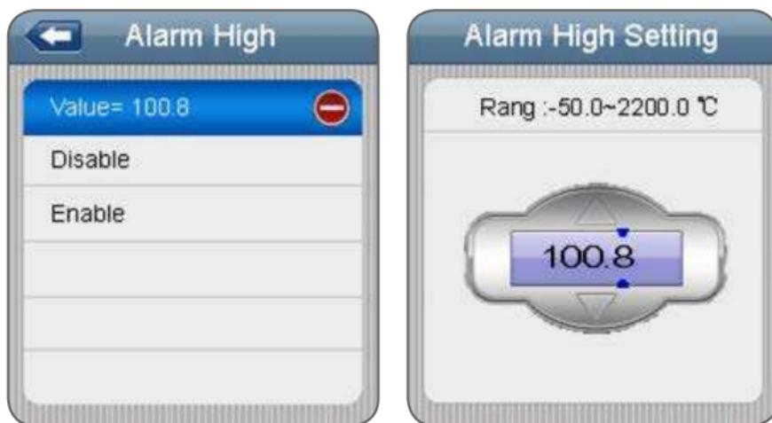
在第一行按输入 (ENTER) 按钮并使用向上 (UP) 和向下 (Down) 按钮可调整该值。按输入 (ENTER) 按钮可确认，按退出 (Esc) 按钮可退出并保存。
