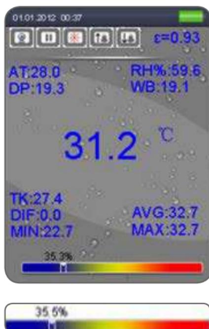
百分比表示所测得红外温度与露点温度的接近程度。在比例达到100%时，测得的红外温度即为露点水平。
