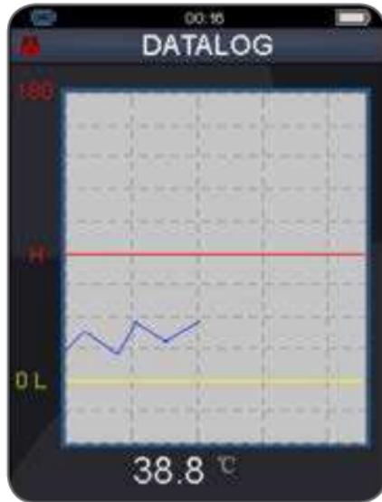
Pulse el disparador una vez para que el registrador de datos empiece a anotar las mediciones. Pulse el botón ESC para salir del modo de REGISTRO DE DATOS y guardar automáticamente los datos en la memoria interna o la tarjeta de memoria.
