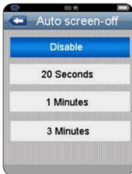
Нажмите кнопки UP и DOWN для выбора времени автоматического отключения дисплея или для отключения функции.
