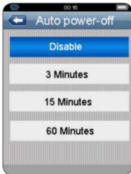
Appuyez sur les boutons Haut et Bas pour sélectionner le délai d'arrêt auto ou désactiver la fonction et sur le bouton Esc pour sortir et enregistrer la sélection.
