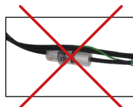
Posição incorreta da câmara de condensados
