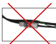
Mauvaise position du pot à condensat
