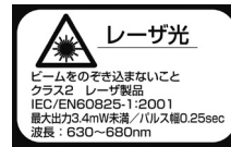
警告説明ラベル
