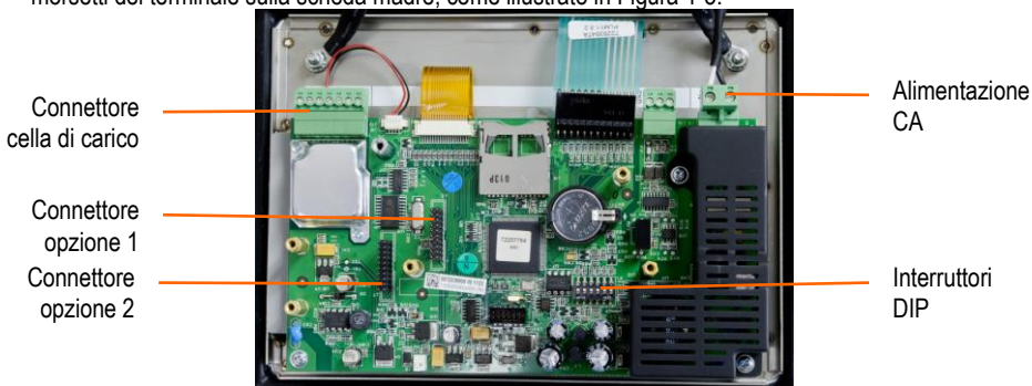
Figura 1-3: Collegamenti scheda madre T72XW, modello CA
