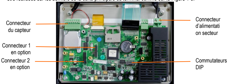
Figure 1-3: Connexions de la carte principale de T72XW, modèle secteur
