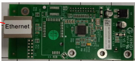
Abbildung 1-6: Optionsplatine für Ethernet-Anschluss
