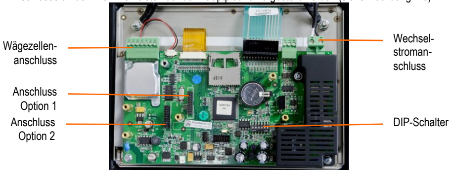
Abbildung 1-3: T72XW Hauptplatine Anschlüsse, Netzstrommodell
