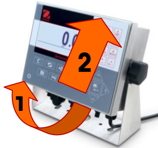
Figura 1-2: Retiro de la cubierta
