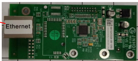
Figura 1-6: Scheda opzionale connessione Ethernet
