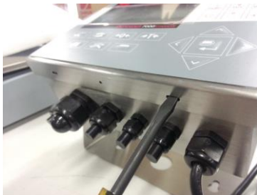
Figure 1-1: Ouverture de l'enceinte pour environnement difficile
