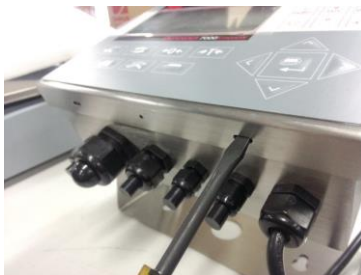
Figura 1-1: Apertura dell'armadietto per ambienti difficili
