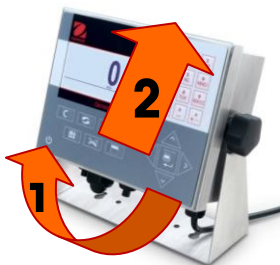
Figura 1-2: Rimozione del coperchio
