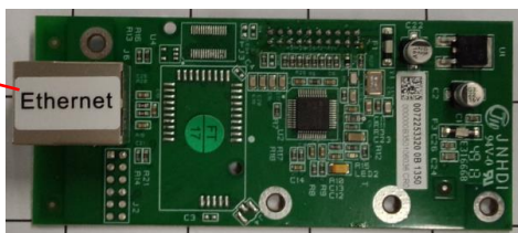
Figure 1-6: Carte en option de connexion Ethernet
