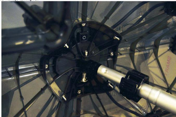
При применении короткого шеста или набора адаптеров SAH22A для брезентовых колпаков необходимо использовать стационарный адаптер шеста, чтобы предотвратить вращение шеста. Поместите стационарный адаптер шеста на прибор SAH22A, закрепив его с помощью предоставленных винтов и крыльчатых гаек. Когда адаптер будет зафиксирован, введите короткий шест и закрепите его с помощью стопорного штифта.
