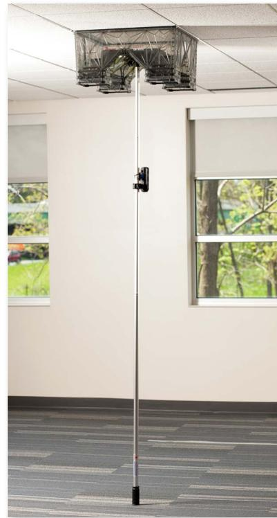
Quando o capuz estiver posicionado corretamente, torça o poste para ajustar seu comprimento, de modo que ele alcance o chão suportando o próprio capuz. Se o capuz não estiver bem preso, reajuste o comprimento do poste.
