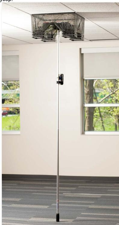
Убедившись в корректном расположении колпака, отрегулируйте высоту шеста путем его прокрутки; шест должен опираться на пол и таким образом поддерживать колпак. Если колпак не зафиксирован надлежащим образом, снова отрегулируйте высоту шеста.
