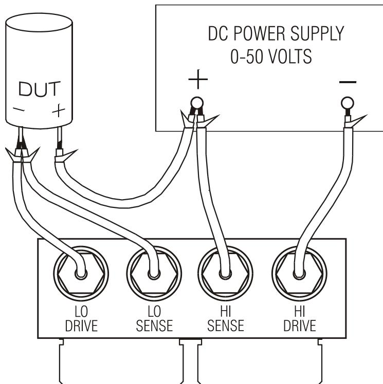
La polarizzazione CC esterna deve essere collegata all'LCR400 e al dispositivo testato (DUT) nel modo indicato nel diagramma. I collegamenti High Drive, High Sense, Low Drive e Low Sense all'LCR400 sono effettuati usando il modulo d'interfaccia opzionale che si inserisce nei connettori Kelvin sulla parte superiore dello strumento.
