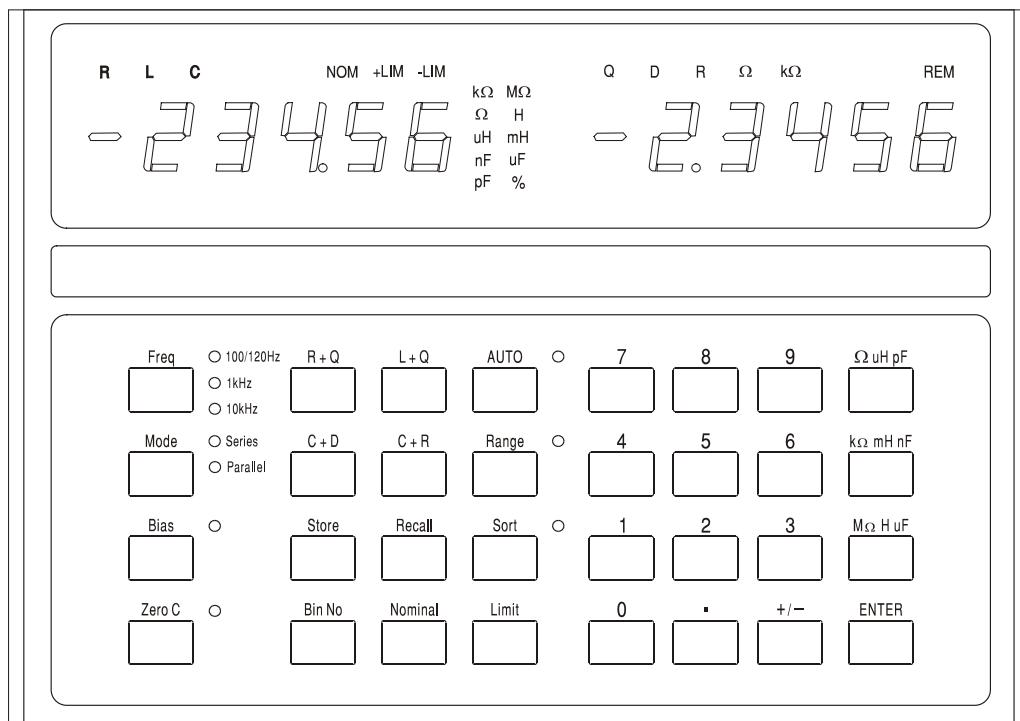
In uso normale il display sinistro a 5 cifre mostra il valore dei parametri principali (L, C o R) e il display destro mostra il valore dei parametri minori (Q, D o R). I parametri visualizzati sono indicati sopra i loro rispettivi valori numerici e le unità del parametro sono indicate alla destra del valore stesso. Un test del display che accende tutti gli indicatori può essere effettuato tenendo premuto qualsiasi tasto mentre lo strumento è acceso.
