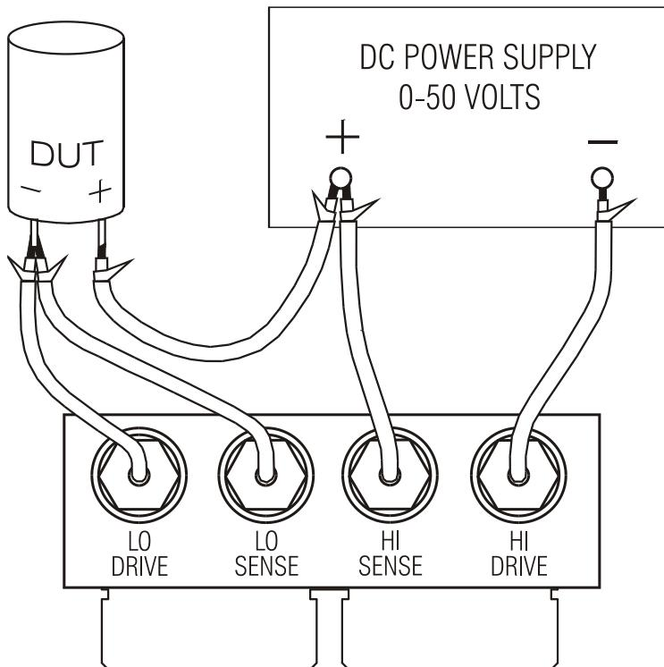
La polarización externa de CC debe conectarse al LCR400 y al DUT como se indica en el diagrama. Las conexiones Impulso Alto, Alta Sensibilidad, Impulso Bajo y Sensibilidad Baja al LCR400 se efectúan utilizando el módulo de interfaz optativo que se inserta en las conexiones Kelvin situadas en la parte superior del instrumento.
