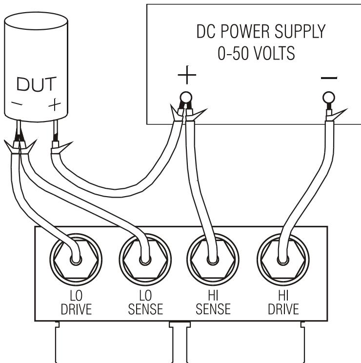
Die als Gleichspannung von außen angelegte Vorspannung muss wie in der Abbildung an das LCR400 und an das zu prüfende Bauteil angeschlossen werden. Die Anschlüsse "High Drive", "High Sense", "Low Drive" und "Low Sense" am LCR400 erfolgen über den optionalen Interface-Baustein, der in die Vierleiter-Kelvinklemmen eingeführt wird, die sich oben auf dem Gerät befinden.
