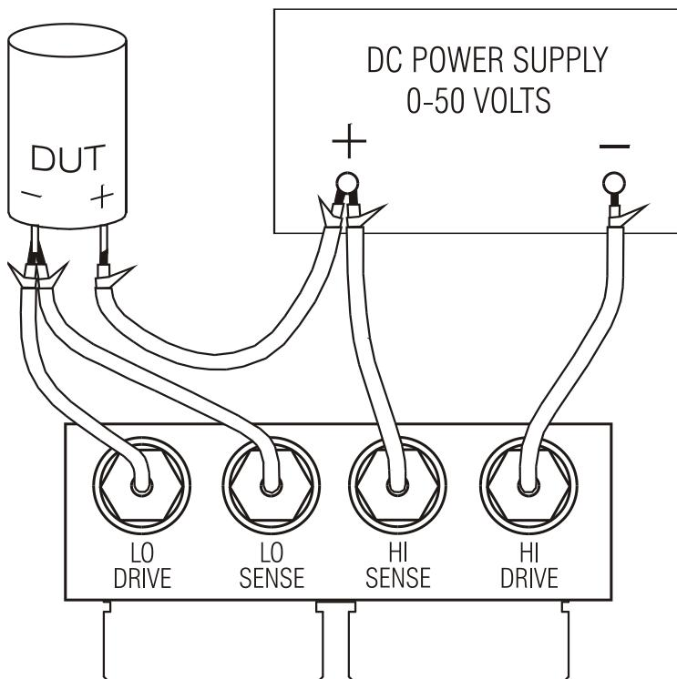
La polarisation externe CC doit être connectée au LCR400 et au dispositif testé, comme indiqué sur le schéma. Les branchements High Drive, High Sense, Low Drive et Low Sense au LCR400 s'effectuent à l'aide du module d'interface en option qui s'insère dans les connecteurs Kelvin sur le haut de l'instrument.
