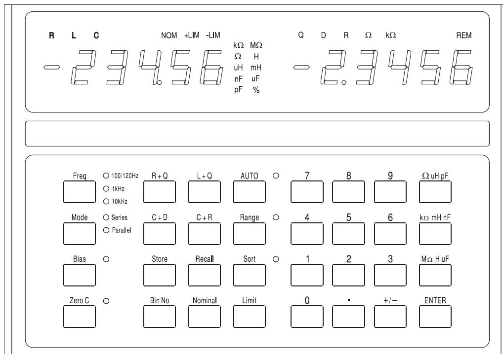
Im Normalbetrieb wird auf der linken 5-stelligen Anzeige der Wert des Hauptparameters (L, C oder R) und auf der rechten Anzeige der Wert des Nebenparameters (Q, D oder R) angezeigt. Die Art der Messgrößen wird über dem Messwert im Display angezeigt, die Masseinheiten werden rechts vom Wert angezeigt. Ein Anzeigentest, bei dem alle Kontrollleuchten eingeschaltet werden, erfolgt durch Niederhalten einer beliebigen Taste bei eingeschaltetem Gerät.
