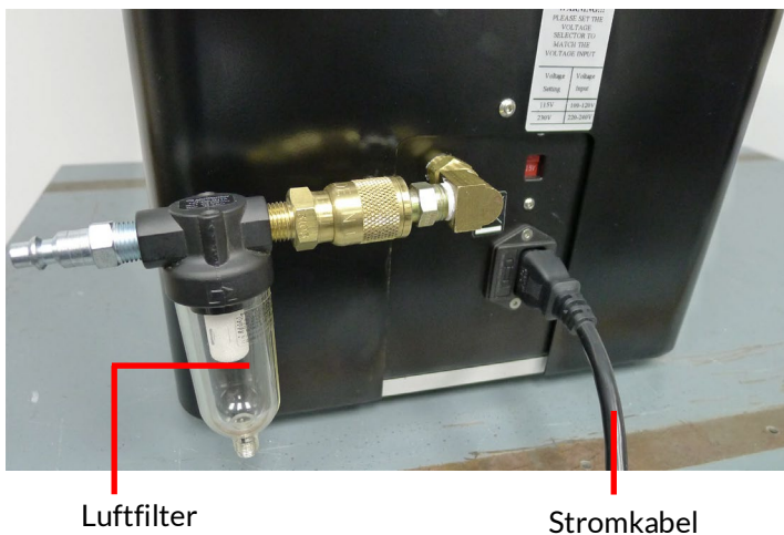
Bild. 9.0 Anschluss von Druckluft und Strom
