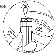
Figura 1: Extracción de la cubierta de las pilas
