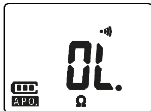
Figura 2-10 Valore continuità circuito aperto sul display
