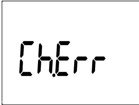
Figure 6-3 Alarme des bornes de charge
