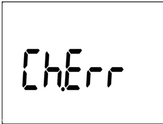
Figura 2-17 Alerta de terminal de carga
