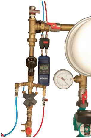
Bild 3.1.3: Vor Einschalten des Wöhler DC 17 mit Ventil im Prüfschlauchadapter auf „P = 0“ stellen. Das Ventil an der roten Prüfleitung bleibt geschlossen.
