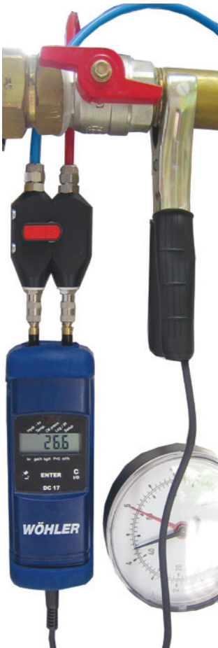
Bild 3.2.1: Messung der Vorlauftemperatur mit Temperaturmesszange (Best.-Nr.: 3619)
