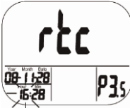
Abb. 16: Einstellung der Stunde (Uhr)
