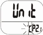
Abb. 12: Auswahl der Temperatureinheit
