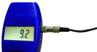
Fig. 43: Collegamento del cavo al Wöhler HBF 420
