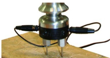
Fig. 31: Connecter le câble a la sonde d'insertion
