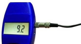
Fig. 32: Connecter le câble au Wöhler HBF 420.
