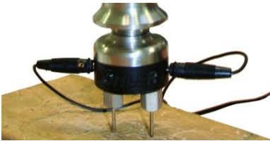
Abb. 9: Anschluss des Verbindungskabels an die Einschlagsonde
