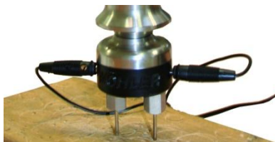
Afb. 20: Aansluiting van het verbindings-snoer op de inslagsonde
