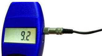
Abb. 10: Anschluss des Verbindungskabels an das Wöhler HBF 420
