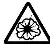
Danger!: Blast Hazard
