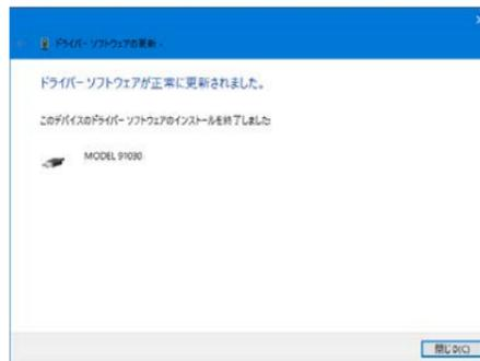
10. コントロールパネルのデバイスマネージャーの「ユニバーサルシリアルバスコントローラ」に、「MODEL 91030」が表示されることを確認してください。
