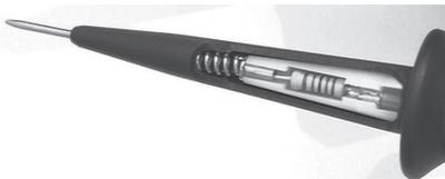
Hohe Sicherheit bietet das Gerät durch zwei Vorwiderstände unmittelbar hinter den beiden Prüf-
