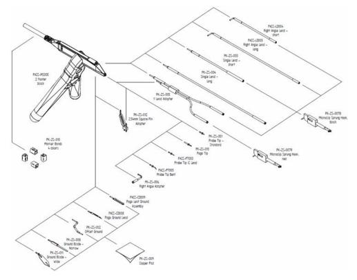
ZS1000, ZS1500, ZS2500 Probe Exploded-View Diagram
