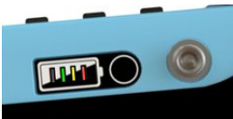
图 2：电池状态指示灯
