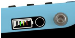
3 pav.: Akumulatoriaus būsenos indikatorius
