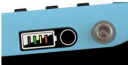
2. att.: Akumulatora statusa indikators
