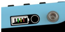
Rysunek 2: Wskaźnik stanu akumulatora
