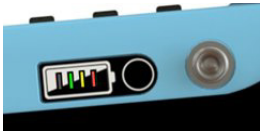
Figure 2 : Témoin d'état de la batterie
