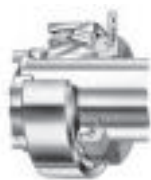
图4. HMV液压螺母将轴承推进到紧定套上
