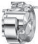
Bild 7. Herausziehen einer Abziehhülse aus einer kegeligen Lagerbohrung
