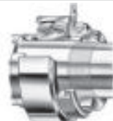
Figura 6. Tuerca HMV y tuerca de retención especial para la colocación de un manguito de desmontaje
