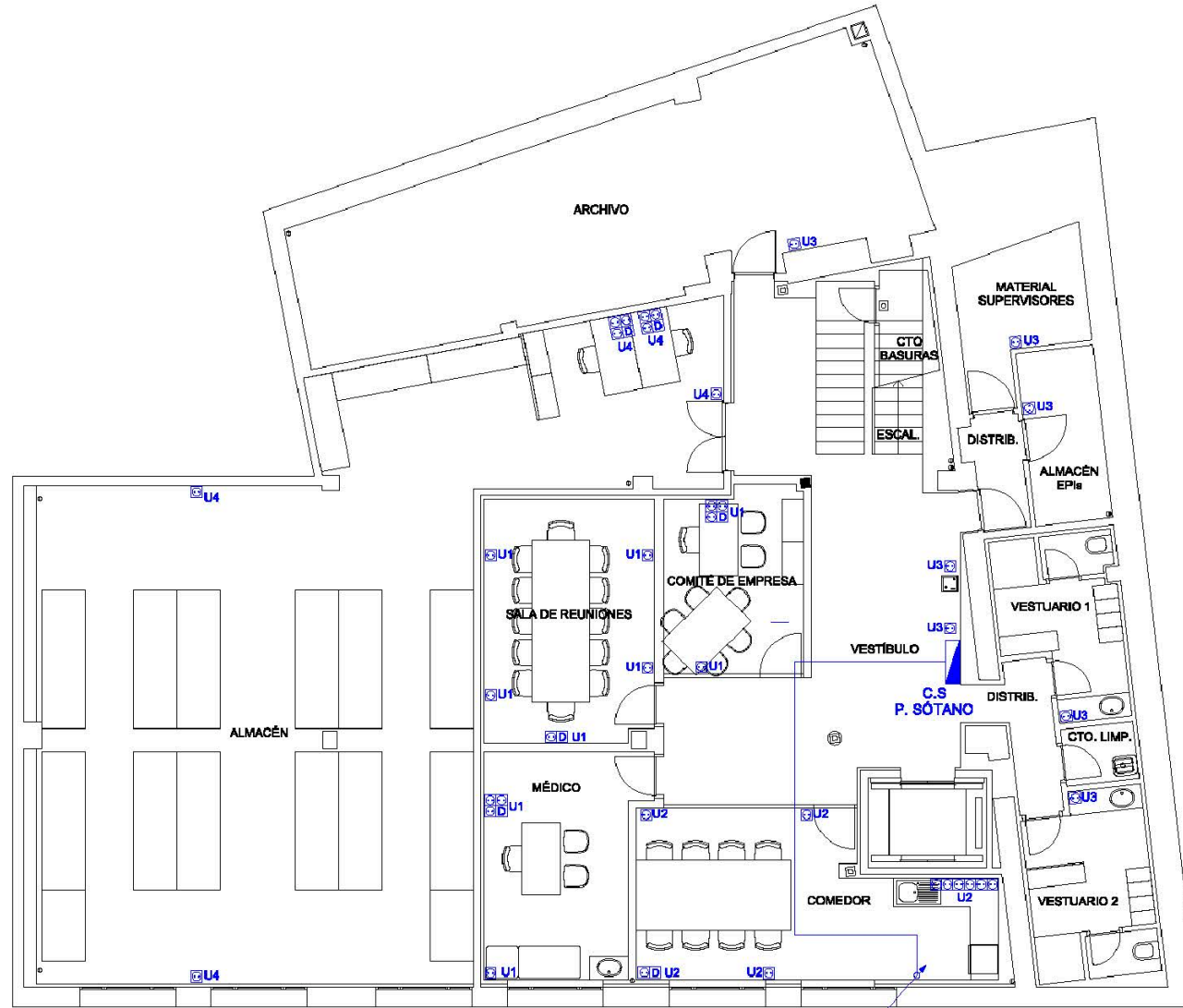
Viene de P. Baja C.S. P. SÓTANO: RZ1-K(AS) 4x8 + TT 1x8 mm 2 0,8/1 kV Ø25 mm
