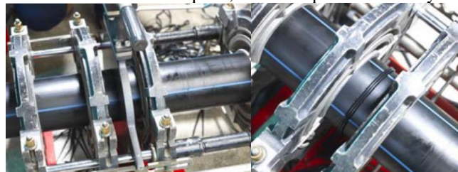
Posicionar los elementos a soldar en la máquina, fresar las partes a soldar y verificar la alineación
