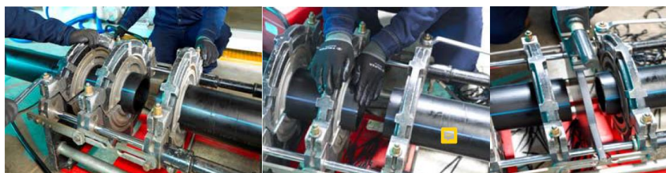
Posicionar los elementos a soldar en la máquina, fresar las partes a soldar y verificar la alineación
