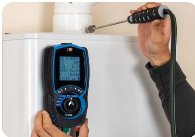
Contrôle de combustion
