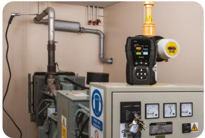
Analyse de combustion avec sonde CHSP5 en option
