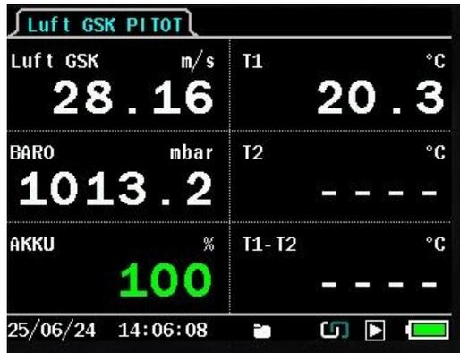
2. Für eine genaue Durchflussmessung sollten Sie auch die Gastemperatur messen - Wenn keine Temperatursonde verwendet wird, nimmt Ihr Abgas-messgerät die interne Umgebungstemperatur als Standard.
