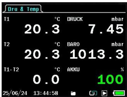
Für die Messung der Differenztemperatur verbinden Sie eine weitere Temperatursonde mit einem Typ-K-Thermoelementstecker mit dem Umwelttemperaturanschluss T2 Ihres BRIGON 750.
