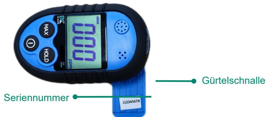
Verwenden Sie den numerischen Teil der Seriennummer, um Ihren KANE LINK-Abgasmessgerät zu koppeln.
