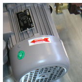
Abb. 3 Pfeil mit Angabe der Drehrichtung
