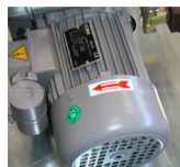
Fig. 3 Freccia indicante il senso di rotazione
