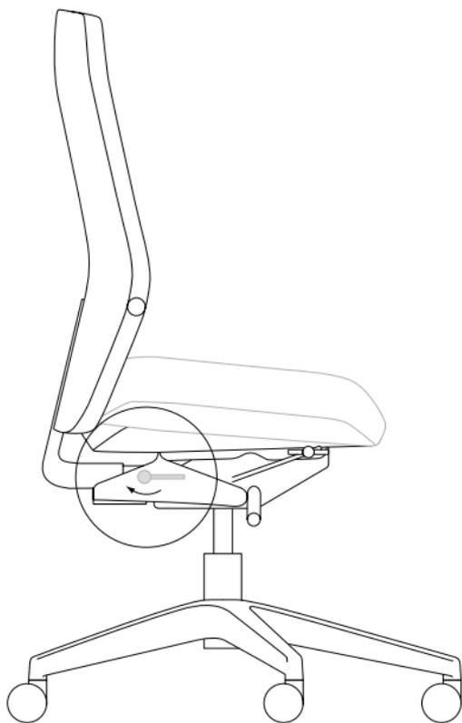
**Sitztiefenverstellung** | *Seat depth adjustment* | *Réglage de la profondeur du siège* | *Zitdiepteverstelling*
