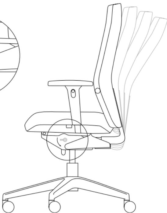
**i-Seating-Funktion mit Öffnungswinkel-Begrenzung** | *i-Seating--Control feature with opening angle lock* | *Fonction i-Seating avec limitation de l'angle d'ouverture* | *i-Seating--Control met instelbare openingshoek*
