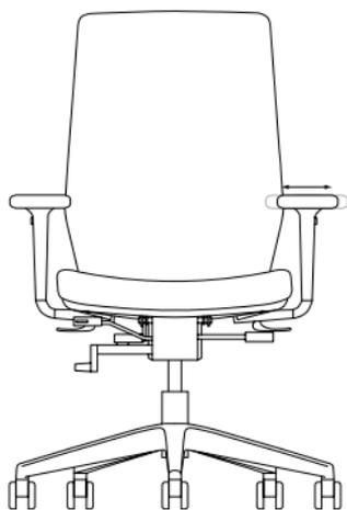
**Arretierung Rückenöffnungswinkel synchron** | *Locking of the opening angle of the backrest synchro* | *Blocage de l'angle dossier/assise synchrone* | *Vergrendeling openingshoek rugleuning synchroon*
