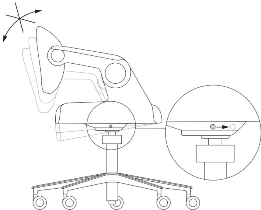
**Stopp-Funktion Gasfeder I** „Stop“ feature for gas lift I Fonction d'arrêt du vérin pneumatique I Stopfunctie gasveer
