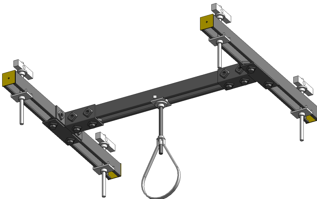
Figur 9 – H-konstruksjon laget av montasjeskinner type 41. Her får vi økt antall festepunkter til fire.
