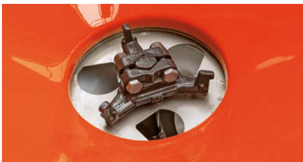
Бъркалката осигурява равномерно подаване на тора
