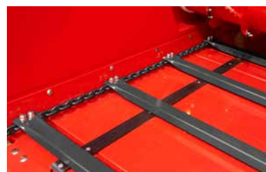
Les bandes "UltraGlide" réduisent l'usure du fond de caisse à son minimum.
