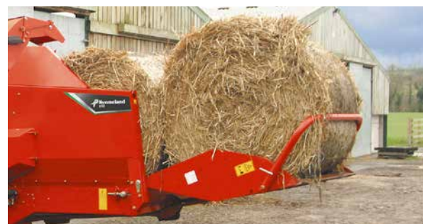
La conception spéciale de la porte arrière permet de transporter une balle ronde supplémentaire.
