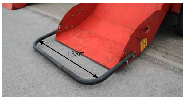
La conception large de la porte arrière permet un chargement plus facile des balles.
