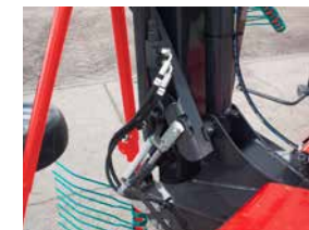
Verrouillage hydraulique du transport (en option).
