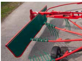
Planche d'andainage repliable automatiquement avec support de stationnement
