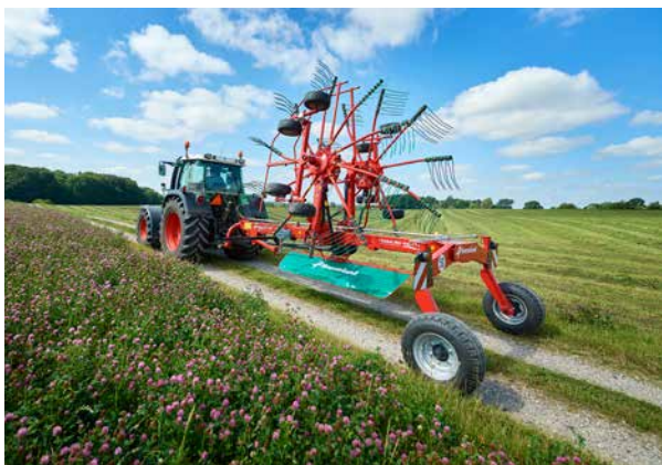
Les andaineurs centraux sont convertis hydrauliquement en position transport depuis la cabine du tracteur.
