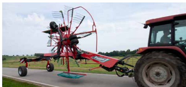
Hauteur au transport inférieur à 4 m
