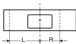
Verbindliches Maß bei symmetrischem und asymmetrischem Schnitt
