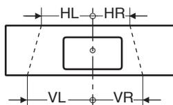
Verbindliches Maß bei symmetrischem und asymmetrischem Schnitt
