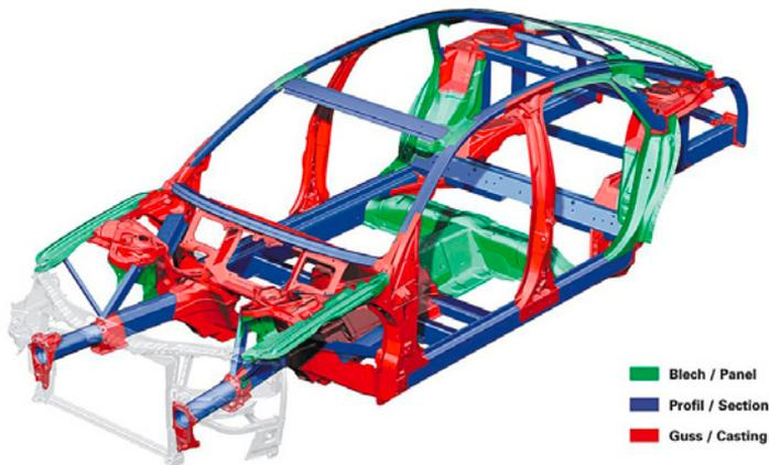
**Bild 3** Spaceframe einer Automobilkarosserie. Blech: Tiefziehteil
