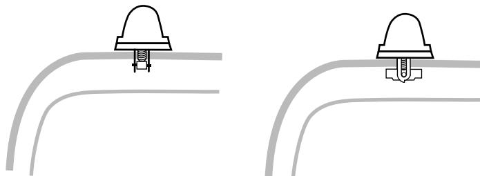
**17** Inserte el tornillo en el tornillo de fijación. No ajuste completamente.
