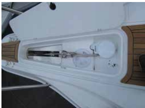
Eksempel på montasje av MAXI 34D i Joda 370
