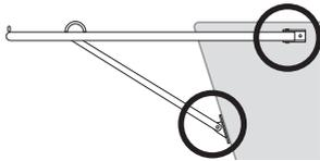
Täta med Sikaflex vid infästningarna mot skrovet. Use Sikaflex on the fittings.
