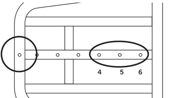
Använd hål 4+5 eller 5+6 för fäste av code-0 Use any hole 4+5 or 5+6 for mounting of code-0
