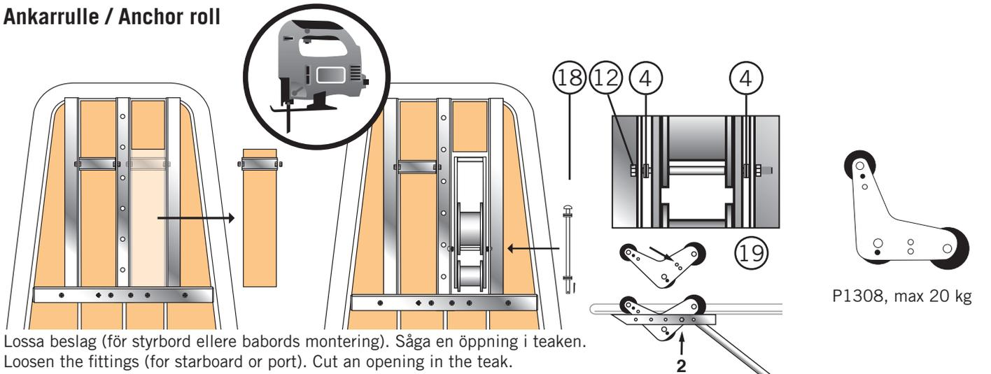
Lossa beslag (för styrbord eller babords montering). Såga en öppning i teaken. Loosen the fittings (for starboard or port). Cut an opening in the teak.
