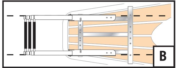
Se till att ramsidorna monteras parallellt så att inte stegen fastnar när den fälls in.
