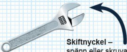
**Skiftnyckel** – spänn eller skruva loss bultar, rör och kranar.
