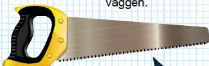
**Såg** – används för att såga av något i rätt längd.
