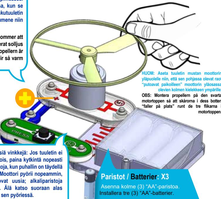
HUOM: Aseta tuuletin mustan moottorin yläpuolelle niin, että sen pohjassa olevat raot "putoavat paikolleen" moottorin yläosassa olevien kolmen kielekkeen ympärille.
