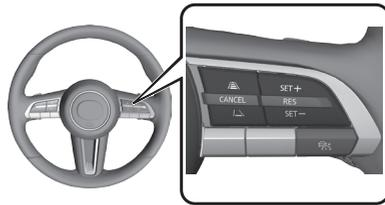
Bei Fahrzeugen mit Automatikgetriebe ergänzt eine Stauassistentz-Funktion das System. Diese bremst das Fahrzeug im Stop-and-go-Verkehr folglich bis zum Stillstand ab. Setzt sich das voraus befindliche Fahrzeug innerhalb von ca. fünf Sekunden wieder in Bewegung, setzt das Fahrzeug automatisch seine Fahrt fort.
