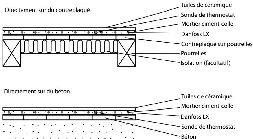
Autre façon : il est recommandé d'utiliser du ciment autonivelant pour les grandes surfaces ainsi que pour les matériaux de recouvrement suivants : bois d'ingénierie, parquet lamellaire, parquet flottant, vinyle, linoléum et tapis.
