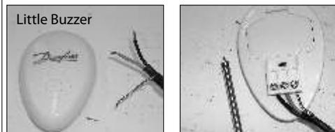
Debe medirse la resistencia entre los dos conductores, azul y negro. Compare la medida de resistencia con la que figura en la etiqueta del producto (en el cable de alimentación). Registre la resistencia en la tarjeta de la garantía.
