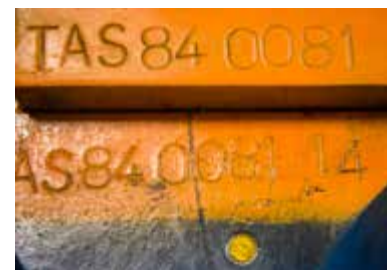
Før ble hver del merket manuelt, og koden ble notert ned for hånd. Nå har delene fått en brikke som skannes.
