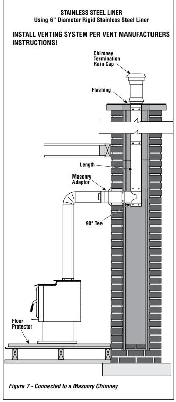
YOUR CHIMNEY INSTALLATION MUST COMPLY WITH LOCAL BUILDING AND FIRE CODES.
