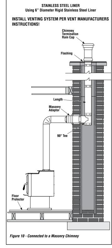
YOUR CHIMNEY INSTALLATION MUST COMPLY WITH LOCAL BUILDING AND FIRE CODES.
