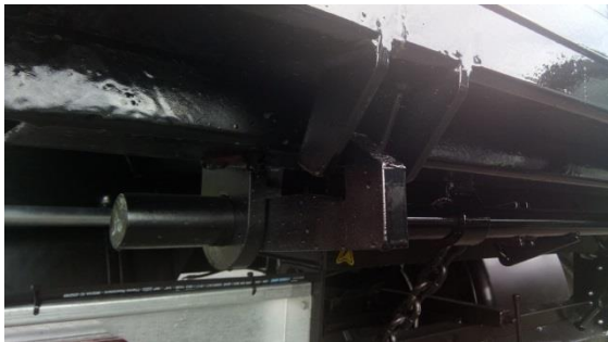
Ouverture hydraulique de la porte avec verrous de sûreté automatiques et tôles de protection du vérin de porte
