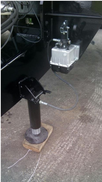
Béquille hydraulique avec pompe manuelle
