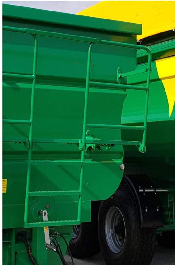
**Balcon avant pliable**
