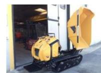
**Transporteur à chenilles 1800Kg de charge, benne rotative, entrainement HYDRO, largeur 130cm**
