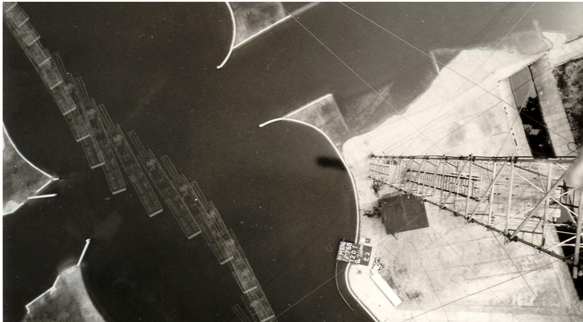
Modeloplossing voor de verbetering van de bevaarbaarheid van de rivierkruising Wijk bij Duurstede met behulp van de de zogenaamde. "Eieren van Thijsse", 1968. Bron: archief Waterloopkundig Laboratorium
