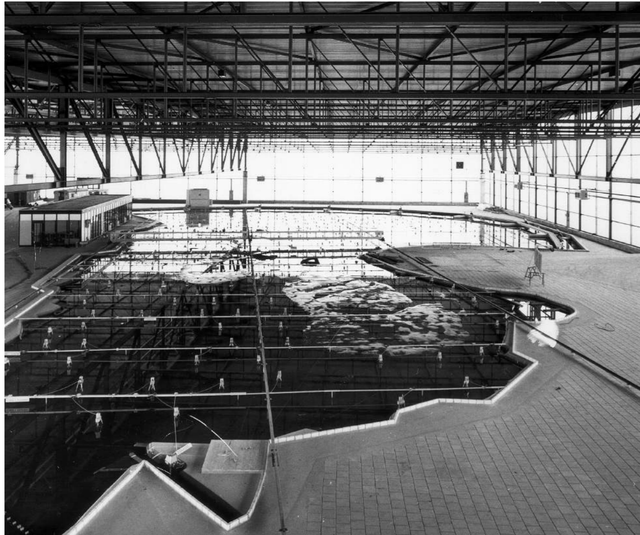
Het model van de Oosterschelde, ca. 1970. Bron: archief Waterloopkundig Laboratorium
