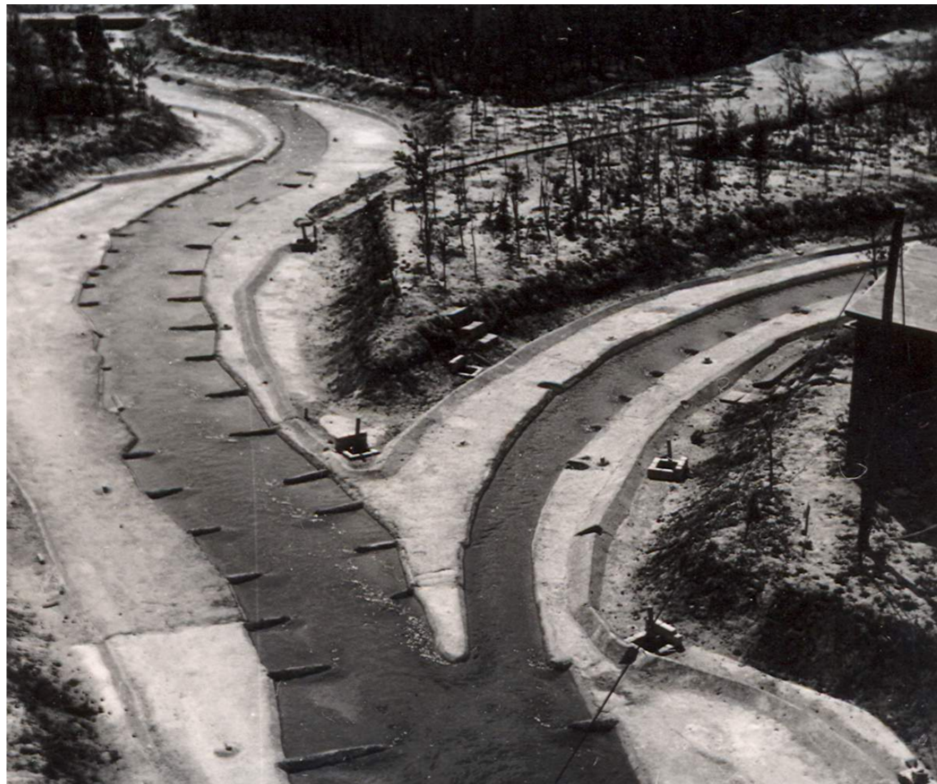
Het riviermodel van Westervoort, 1957. Bron: archief Waterloopkundig Laboratorium
