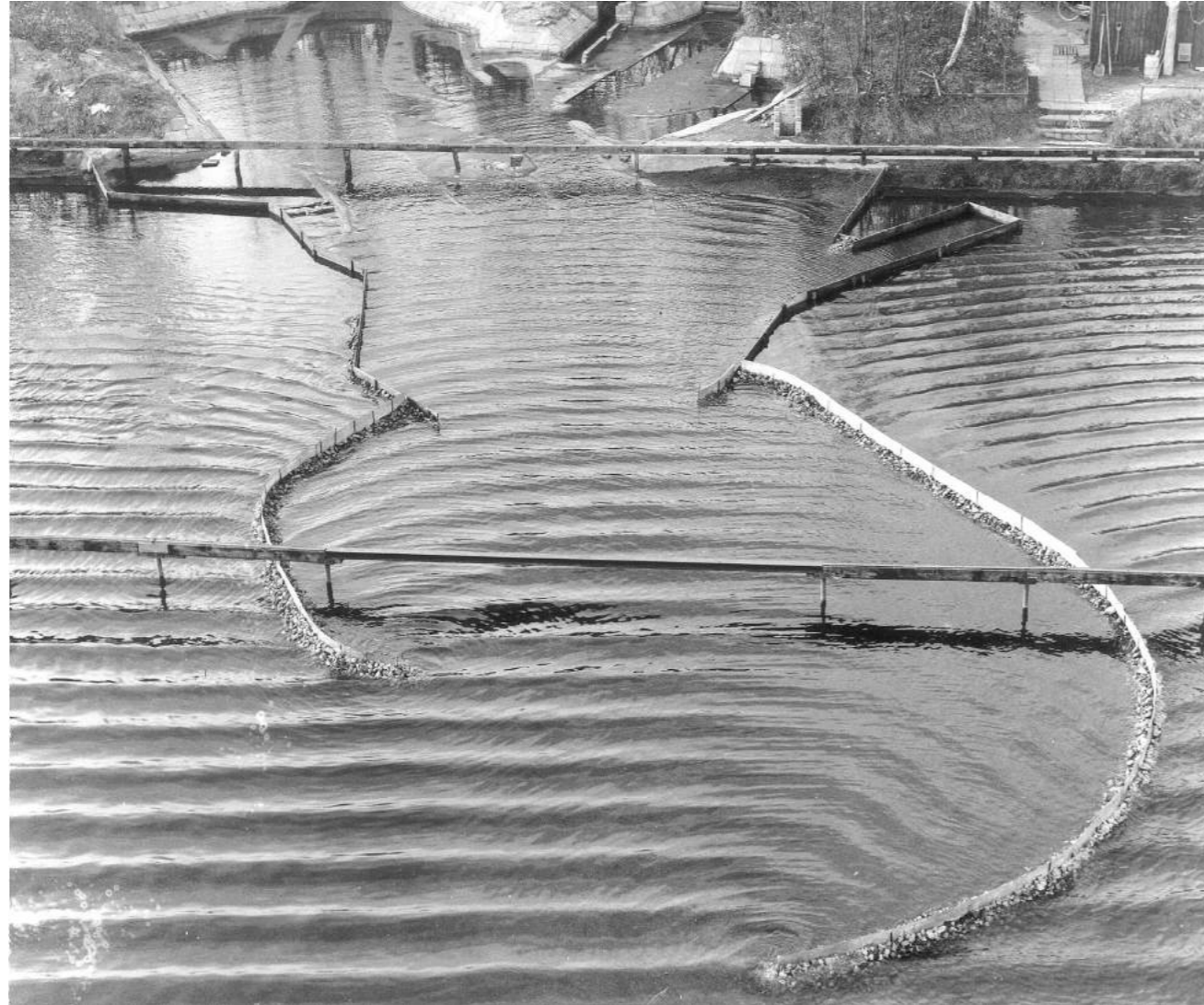
Het model van de haven van Ijmuiden, 1956. Bron: archief Waterloopkundig Laboratorium
