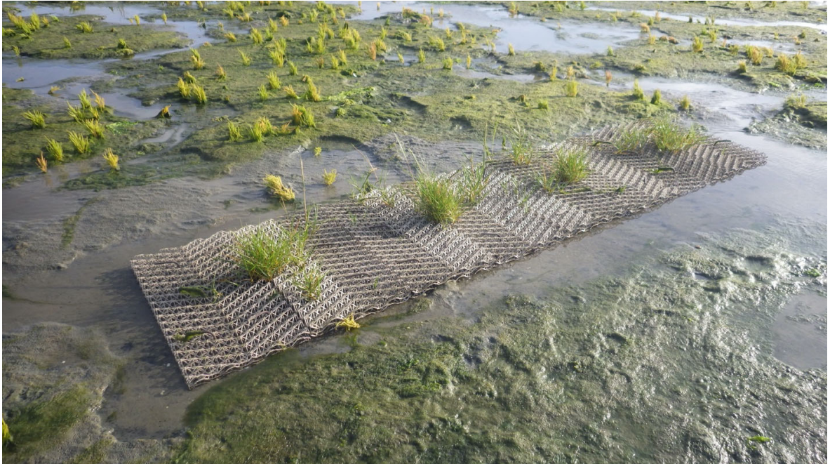
Figuur 4.4. Engels slijkgras groeit en overleeft goed in BESE-structuren bij de Dortsman (Oosterschelde).
