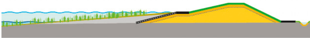
Figuur 5.2. Traditionele dijk met kwelder die als hoger voorland bijdraagt aan de golfreductie en via natuurlijke aanwas mee groeit met de zeespiegelstijging. Voorbeeld uit Van Loon-Steensma et al., 2014.
